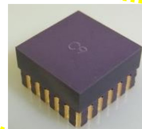
真空断熱型量子部外観 (11 × 11 × 5mm 3 )
